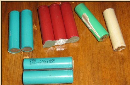
Блоки элементов 18650 и отдельные элементы, применяющиеся в аккумуляторах ноутбуков
